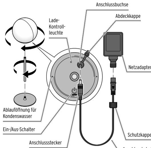
2. Stecken Sie das eine Ende des Anschlusskabels in die Anschlussbuchse auf der Unterseite des Lampenschirms und das andere Ende in die Anschlussbuchse am Netzadapter. Drehen Sie die Schutzkappe fest.
